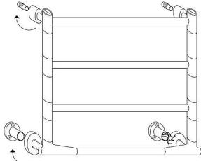
6- Eseguire il collegamento elettrico e fissare l'attacco (**Attenzione!**
