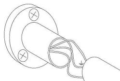
7- Fissare l'articolo e serrare le viti a grano in modo parallelo alla parete(**Attenzione! Solo dopo questa operazione si può riattivare la rete elettrica!**)/ Fasten the article and tighten the grain screws parallel to the wall (**Attention! Only after this operation you can turn on the power supply!**) / Закрепите изделие и затяните винты для зерна параллельно стене (**Внимание! Только после этой операции вы можете включить источник питания**)
